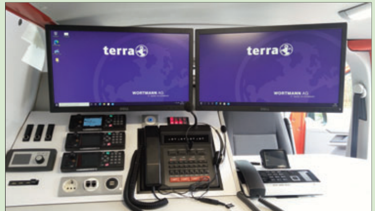
Arbeitsplatz für die Führungsunterstützung: Funkbedienung, PC-Arbeitsplatz, Telefon, Multifunktionsdrucker (nicht im Bild)
